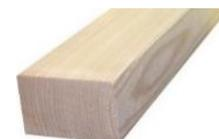
Accoya ist ein acetyliertes Holz, welches in einem Verfahren der chemischen Holzmodifikation mit Essigsäureanhydrid behandelt wurde. Somit wird die Besiedlung durch holzerstörende Pilze oder Insekten erschwert. Die gebrauchstaugliche Eigenschaften für den Aussenverbau werden somit verlängert. Essigsäure ist nicht toxisch.
