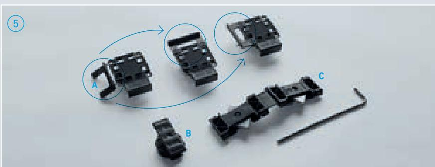
Die Konstruktion einer Twinson Terrasse ist einfach und gut durchdacht. Als Träger dient die dreieckige Grundplatte (Triangel), in die der Aluminiumrahmen einrastet. Alle Höhenunterschiede oder unebenen Flächen können mit den höhenverstellbaren Drehfüßen und Adapter ausgeglichen werden. Der Aluminiumrahmen wird auf dieser Unterkonstruktion aufgesetzt, auf den die Twinson Terrassendielen gelegt werden.
